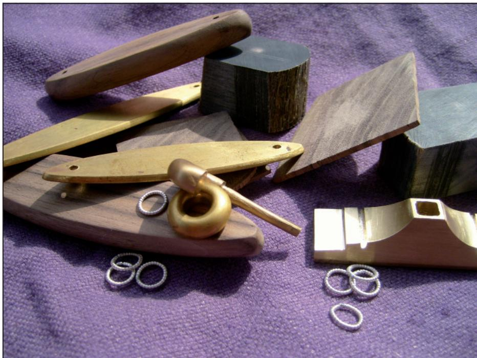
Dann habe ich die beiden Bleche mit der Fase nach innen auf der Breitseite aneinander geklebt. Somit entstand ein Werkzeug, das auf der gesamten Längskante eine nach innen verlaufende Rille aufweist.
