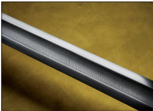
Angefangen bei der Klinge, die nicht wie im Original aus einem torsions-damaszierten Kern und angeschweißten Schneiden bestand, sondern aus homogenem Stahl, ohne Damast.
